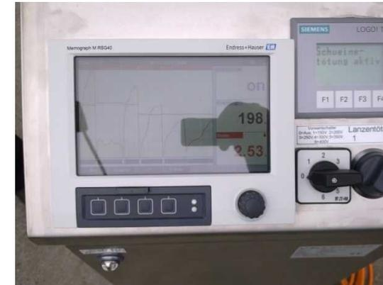
Eine Kontrolle der Schlüsselparame-ter Spannung, Stromstärke und Zeit erfolgt während und nach dem Einsatz unter Nutzung der Anzeige- und Registriereinrichtung vom Typ M RSG40 der Firma Endress+Hauser.
