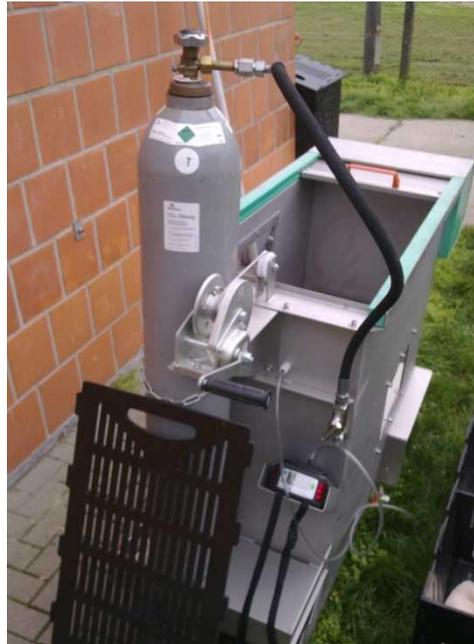
Das zur Betäubung und Tötung erforderliche CO<sub>2</sub> wird aus einer 25 kg- Steigrohrflasche mittels Schneerohr der Anlage zugeführt bis eine CO<sub>2</sub>-Konzentration von mindestens 80 % und ein Restsauerstoffgehalt von 3 % (besser: unter 2 %) erzielt sind.
