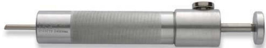
Durch Herausziehen des Schussbolzens am Ring oder herstellerabhängig an der Scheibe bis zum Einrastpunkt wird die Schussbolzenfeder gespannt. Bei Betätigen des Abzugshebels wird der Schussbolzen freigegeben und durch die Federkraft in den Schädel des Tieres getrieben.
