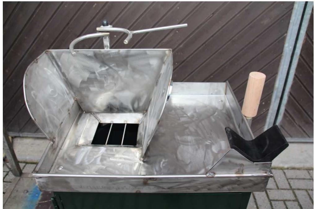
Neben der Fixierung der Ferkel bis 5 kg im Rahmen der Betäubung und Tötung ermöglichen das Piglet Case und die Piglet Box die Kontrolle des Betäubungs- und Entblutungserfolges, das Auffangen des Blutes sowie das Aufbewahren der Kadaver in Sammelbehältnissen.
