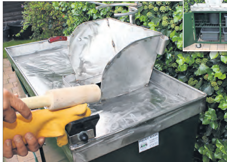
Der Piglet Case ist ein mobiler Servicewagen, mit dem Saugferkel unter 5 kg Lebendgewicht betäubt und getötet werden können. FOTO: AWS GMBH
